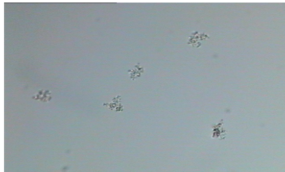
Figura 3 - Amostra polida com CeO 3 tratada por 48h (lente de 40x).
