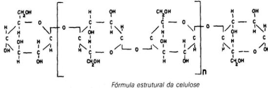
Así, los átomos de hidrogeno cargados positivamente en esos grupos (OH) tienen una alta afinidad como los iones negativos del aceite, resultando en la absorción de iones negativos en la superficie del papel. Y como es sabido, el papel aislante tiene una elevada tendencia a absorber impurezas del aceite, impurezas éstas que podrían ser vistas como compuestas de exceso de electrones.
