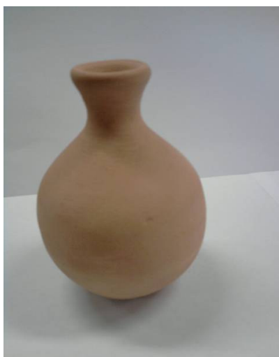
Figura 1 - Peça sinterizada confeccionada com AP + 15% de lodo seco e moído.
