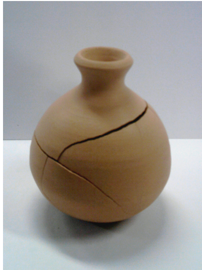
Figura 2 - Peça sinterizada confeccionada com AC + 15% de lodo seco e moído.
