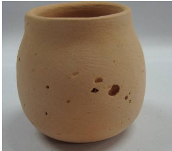
Figura 2 - Furos e bolhas em amostra sinterizada confeccionada com massa cerâmica com incorporação de 15% de lodo in natura .
