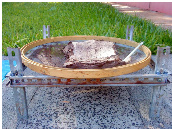
Figura 2 - Leito de secagem suspenso em tela (LST).
