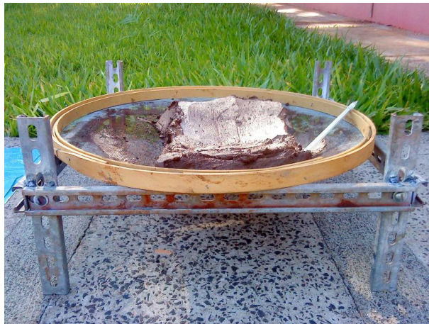
Figura 2: Leito de Secagem Suspenso em Tela (LST)
