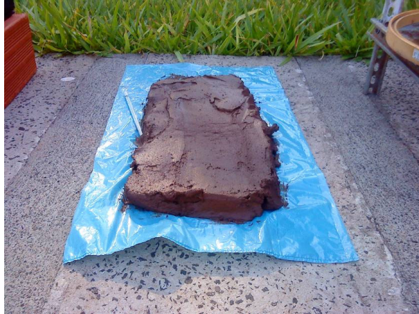
Figura 1: Leito de Secagem Sobre Piso de Concreto (LPC)
