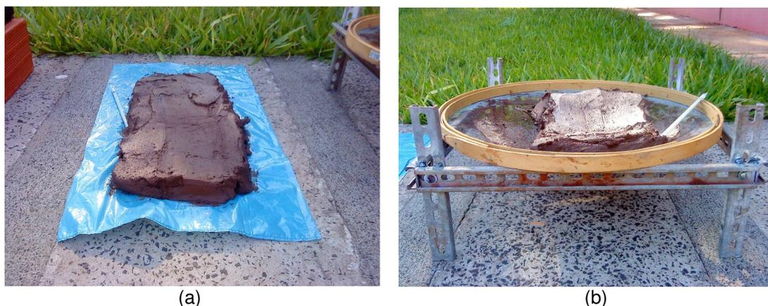
**Figura 1** - Leitos de secagem (a) sobre piso de concreto e (b) suspenso em tela.
