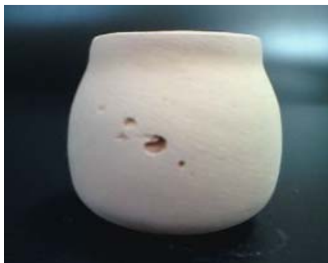
Figura 1 – Furos e bolhas em amostra com 10% de lodo e 90% de argila utilizada no Ñandeva.
