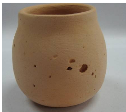
Figura 2 - Furos e bolhas em peça sinterizada confeccionada com massa cerâmica com incorporação de 15% de lodo in natura .
