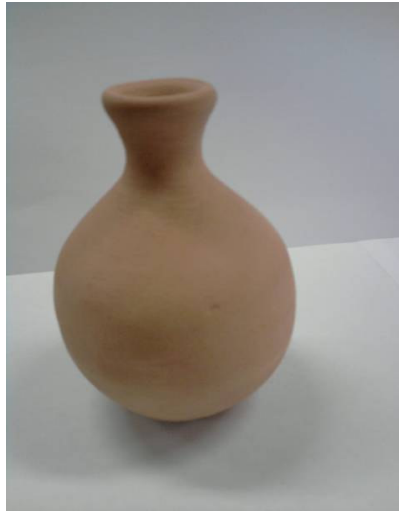
Figura 3 - Peça sinterizada confeccionada com massa cerâmica com incorporação de 15% de lodo seco e moído.
