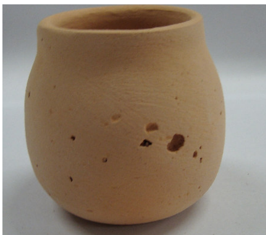
Figura 1. Furos e bolhas em amostra sinterizada de massa cerâmica com incorporação de 15% de lodo in natura .
