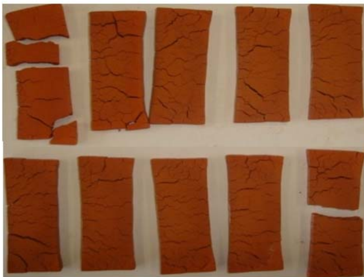
Figura 4.9 – Corpos cerâmicos confeccionados com lodo puro sinterizado na temperatura de 950 °C.
