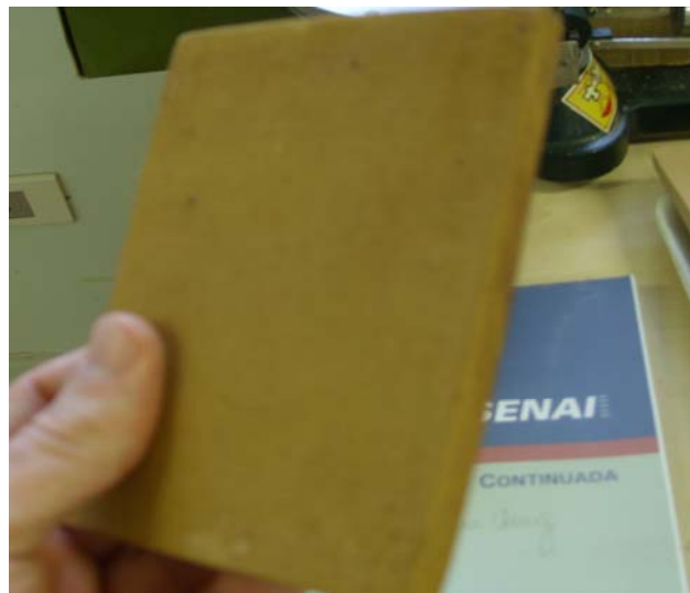
Figura 4.29 – Experimento realizado por artesã do Ñandeva, sinterizado a 900 °C.
