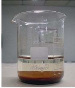
Fig. 1- Produtos da corrosão de amostra de Aço Carbono 1020 pela ação do NaCl 0,1M.
