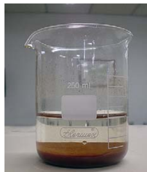
Figura 1: Amostra da obtenção do óxido por separação da solução de NaCl.
