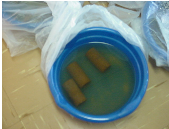
Fotografia IV - Corpos de prova de argamassa epoxídica imersos em solução concentrada de fungos filamentosos.
