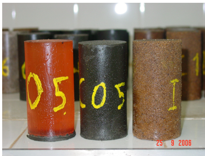
Fotografia I - Corpos de prova de resina epóxi e argamassas epoxídicas.
