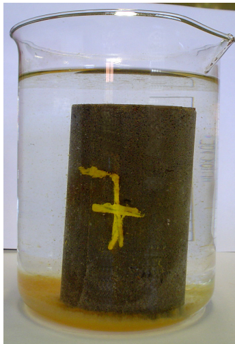
Fotografia III - Corpo de prova de argamassa cimentícia imerso em solução de ácido nítrico.
