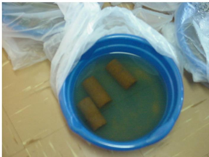
**Figura 1. Corpos de prova de argamassa epoxídica imersos em solução concentrada de fungos filamentosos.**
