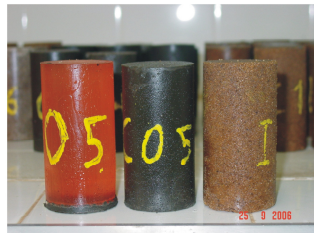
Figura 1 - Corpos de prova de resina epóxi e argamassas epoxídicas
