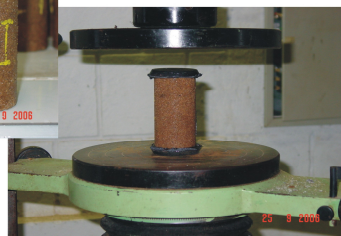
Figura 2 - Ensaio à ruptura por compressão axial
