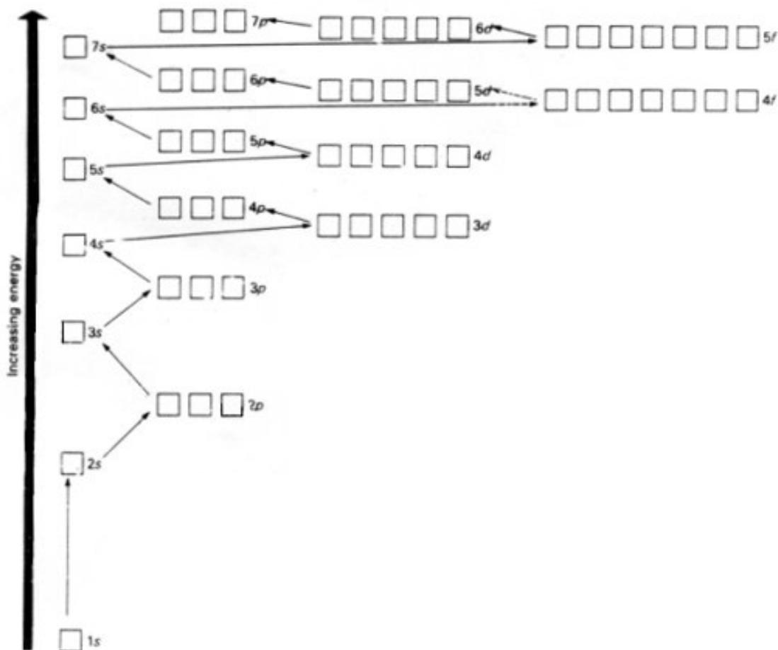
Figura 2.32 - Diagrama de Aufbau.
