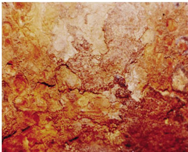
**Figura 9.3** - Corrosão uniforme em chapa de aço-carbono.
