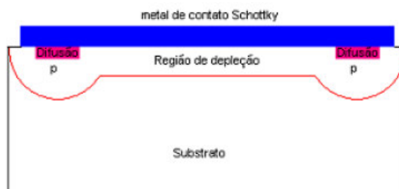
FIGURA 10 – Eliminação da terminação abrupta das bordas do contato
