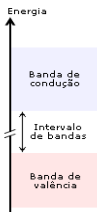
FIGURA 4 - Banda de energia de um material isolante.
