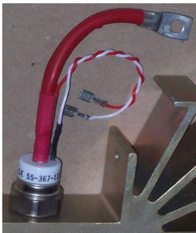
**FIGURA 5** – SCR para correntes máximas de 100 ampères e 1200 volts montado em um dissipador de calor, os dois fios menores são o terminal de gatilho.
