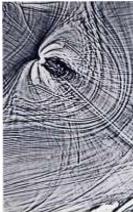
**FIGURA 8** – Micrografia de um vidro que estava apresentando defeitos (defeitos de cordas).
