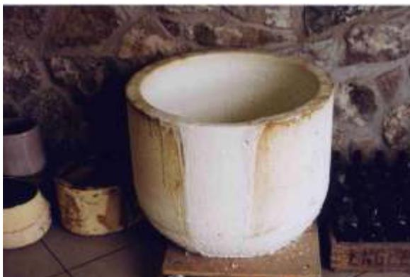
**FIGURA 7** - Cadinho de forno elétrico
