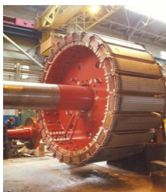
FIGURA 2 – Rotor de um gerador
