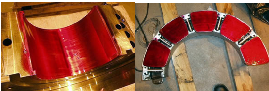
FIGURA 13 – Mancais da turbina e do compressor
