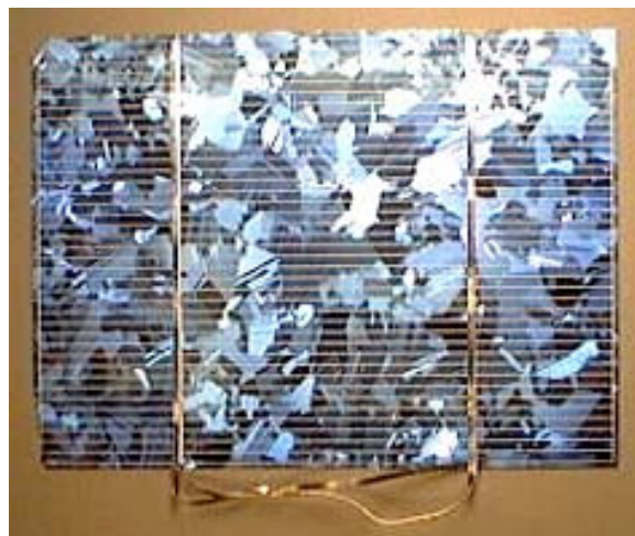
FIGURA 10 – Célula de silício policristalino.
