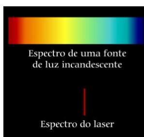
Figura 11 – Espectro contínuo da luz visível e espectro discreto do laser.
