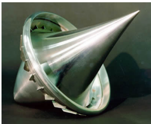
FIGURA 15 – Modelo experimental de nave de luz movida a laser.
