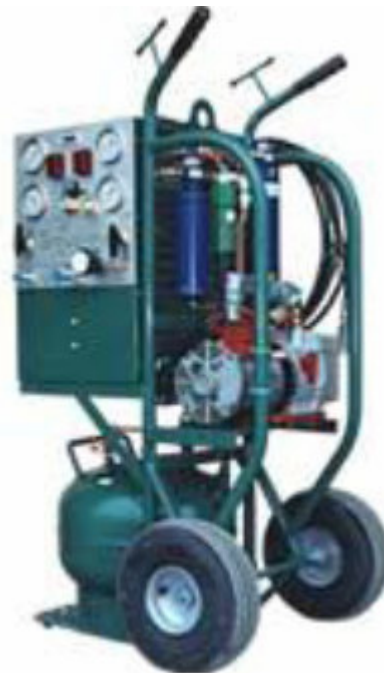
FIGURA 1 – Unidade de recuperação de gás SF 6
