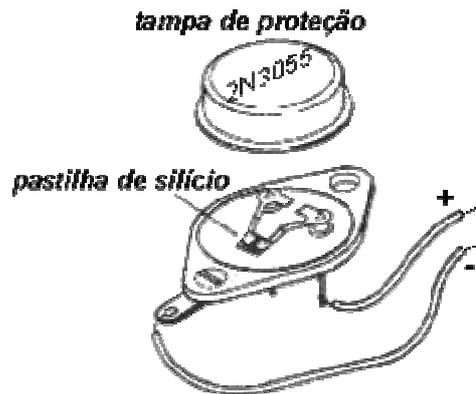
**FIGURA 5.** Esquema de um transistor
