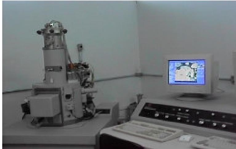
**Figura 5.3** - Microscópio eletrônico de varredura (MEV).
